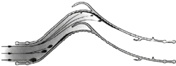
РИСУНОК 15 - ПРАВИЛЬНОЕ НАПРАВЛЕНИЕ ПЛАСТИНЫ КАПЛЕУЛОВИТЕЛЯ
