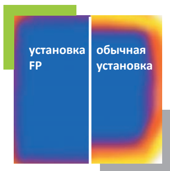
минимализация тепловых мостов
