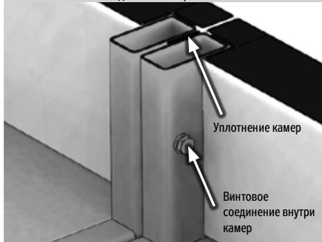
Рисунок 2 – Соединение соединительной рамы при (винт M6x40 и заклепочная гайка)
