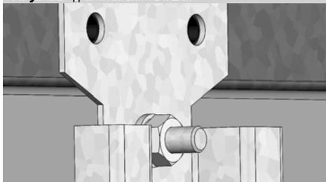
**Шаг 2:** Удалите транспортную стойку жесткости. Винты заслоньте шайбами. Оставшееся отверстие на боковой панели необходимо обеспечить крышкой из нейлоновой втулки. Крышки из нейлоновой втулки и шайбы винтов находятся в пакете, прикрепленном к транспортной стойке жесткости.
