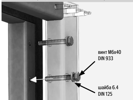
Рисунок 3 – Уплотнение в месте соединения ванн
