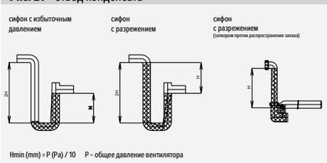
Трубка для отвода конденсата должна выходить в свободное пространство, т.е., она не должна входить непосредственно в закрытую канализационную систему. Перед пуском и после длительной остановки оборудования необходимо залить сифон водой. Сифон можно оборудовать клапаном против запаха и шаровым затвором (при отрицательном давлении). Такой сифон перед началом эксплуатации не заливается.
