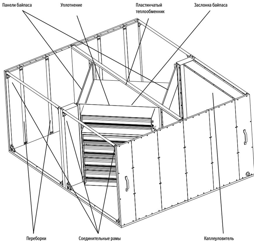
**Рис. 2а** - корпус секции XPXB 28/BS
