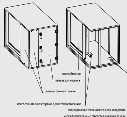
После подключения теплообменников и смесительных узлов к сети, необходимо создать давление воды и обезвоздушить систему, контролировать герметичность соединений и теплообменника, (включая осмотр внутри секции с водяным теплообменником). Производитель не принимает рекламаций за ущерб, нанесенный при разливе жидкости в результате негерметичности соединений и при повреждении теплообменника.
