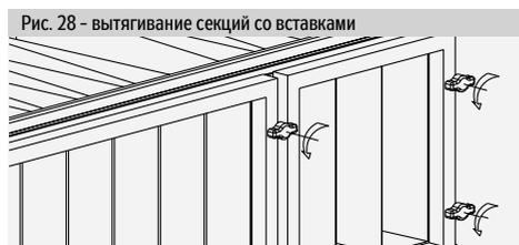
Рис. 28 – вытягивание секций со вставками
