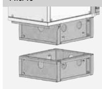
Ротационный рекуператор установок с типоразмером ХР 10 и выше, всегда оборудуется опорной рамой высотой 150 мм. У опорных рам высотой 300 и 400 мм необходимо к рекуператору перед его установкой прикрепить дополнительные рамы (рис. 16).
