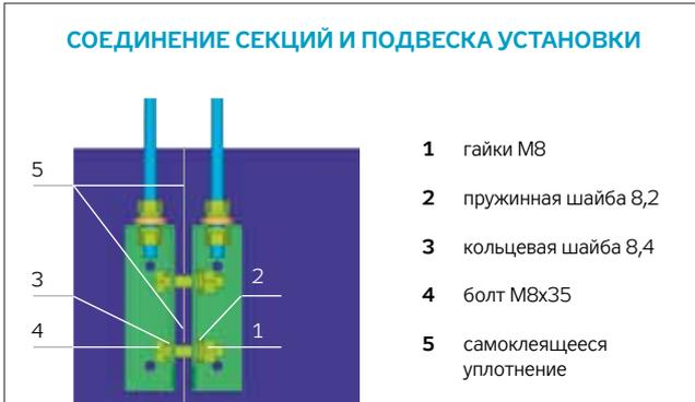
Жесткое соединение секций установки обеспечивается при помощи резьбовых соединений. Соединение установки, состоящей из трех секций, можно осуществить в течение 30 мин.
