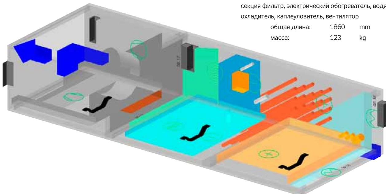
секция фильтр, электрический обогреватель, водяной охладитель, каплеуловитель, вентилятор
