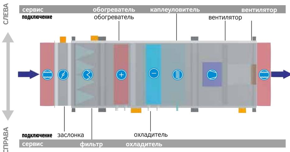
Конструкция FP позволяет комбинировать сторону подключения энергоносителей и сервисные доступы.
