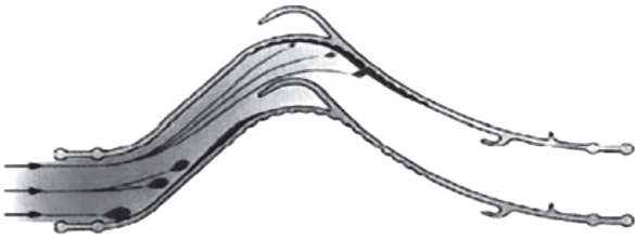
OBRÁZEK 15 – SPRÁVNÁ ORIENTACE LAMELY ELIMINÁTORU
