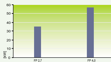
Wärmerückgewinner mit hohem Wirkungsgrad (Einsparungen bei Wärmerückgewinnung im Bezug auf Leistung des Wasserregisters)
