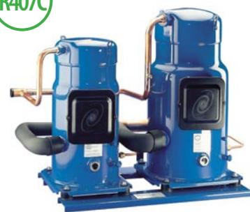
За счет объединения двух компрессоров в tandem, агрегаты обеспечивают наиболее оптимальные режимы производства холода при переменных нагрузках, что отражается повышенными значениями ESEER и IPLV. Низкое электропотребление ведет к снижению эмиссии углекислого газа в атмосферу (низкий индекс TEWI), что отвечает требованиям Киотского протокола.
