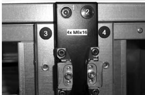
Obrázek 23 – demontáž mezidveřního sloupku
