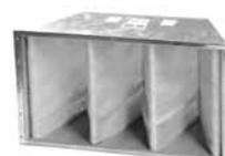
Filtrační vložky VF3 (třída filtrace G3) jsou určeny pro kazety vložkových filtrů VFK. Vložka je tvarově vyztužena a je osazena a utěsněna v kazetě z pozinkovaného plechu. Vložky jsou pouze omezeně regenerovatelné mokrou cestou. Ve vložkách se vyměňuje pouze filtrační tkanina VF3N.
