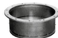
Samočinná podtlaková klapka se montuje přímo na sání střešního ventilátoru. Po vypnutí ventilátoru uzavírá sání a tím zabráňuje samotížnému proudění vzduchu a tepelným ztrátám. Klapku VS lze použít pro přímou montáž do nástavců NK, NDH.
