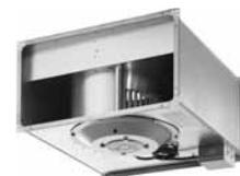
Radiální potrubní ventilátory RP s dopředu zahnutými lopatkami mají elektromotory s teplotní pojistkou vyvedenou do svorkovnice. Ventilátory musí být za provozu chráněny ochranným prvkem ovládaným kontaktem termopojistek (termokontaktů TK). Ventilátory jsou napětově regulovatelné pomocí regulátorů TRN nebo TRRE/TRRD.
