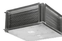
Deskový rekuperátor HRV je konstruován pro vzduchotechnická zařízení jak s paralelním vedením trasy přívodu a odvodu vzduchu, tak kolmým i šikmým pod úhlem 45° a jejich různými kombinacemi. Průtok vzduchu rekuperátorem je křížový. Rekuperátor je osazen teplosměnnou vložkou z tenkých hliníkových plechů. Součástí je souprava na odvod kondenzátu.
