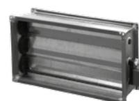
Těsné lamelové uzavírací a regulační klapky LKSX se nejčastěji používají jako směšovací, vstupní a výstupní uzavírací - regulační. Obě koncové polohy (otevřeno–zavřeno) lze omezit mechanickými dorazy na servopohonu. Ovládání je motorické servopohonem s proporcionální regulací polohy s napájením 24 V AC/DC a řízením signálem 0–10 V DC.
