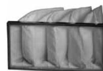
Kapsové filtry KF3 (třída filtrace G3), KF5 (třída filtrace M5) a KF7 (třída filtrace F7) jsou určeny pro kazety kapsových filtrů KFD. Kapsy jsou osazeny a utěsněny v rámečku z pozinkovaného plechu. Vložky jsou neregenerovatelné, po dosažení konečné tlakové ztráty se vyměňují za nové.
