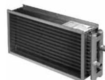
Vodní ohřivače VO jsou vyrobeny z Cu trubek průměru 10 mm (geometrie 25x22) s přesahem navlečenými hliníkovými lamelami s roztečí 2,1 mm. Plášť ohřivače je vyroben standardně z pozinkovaného plechu. Trubkovnice (sběrače) jsou navrženy tak, aby bylo možno ohřivač libovolně otáčet jako pravý i levý, a přesto zachovat protiproudé zapojení. Výkon ohřivače doporučujeme regulovat vždy regulačním uzlem SUMX. Použití regulačních uzlů výrazně snižuje riziko zamrznutí ohřivače.
