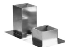
Univerzální nástavce (střešní a potrubní) jsou vyrobeny z pozinkovaného plechu. Zevnitř jsou izolovány deskou samozhášivého polyetylénu tloušťky 20 mm. Nástavce se upevňují nad otvor ve střešní konstrukci. V obou nástavcích je prostor pro zpětnou klapku VS, která se přišroubuje ze spodní strany na základnu ventilátoru.
