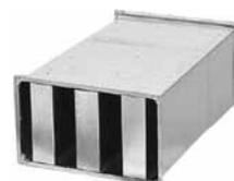
Absorpční tlumiče hluku TKU jsou vyrobeny z pozinkovaného plechu, vnitřní vestavba hluk pohlcujících kulis je tvořena nehořlavými deskami z minerálních vláken s oboustranným speciálním povrstvením nehořlavou netkanou skelnou textilií.
