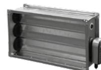
Těsné lamelové uzavírací klapky LKSF s bezpečnostní funkcí se nejčastěji používají jako vstupní uzavírací. Ovládání je motorické servopohonem pro napětí 230V AC. Servopohon klapku uzavře havarijní pružinou i při výpadku napájení, čímž se snižuje riziko zamrznutí vodního ohříváče.
