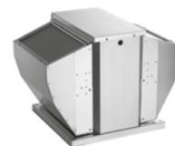
Střešní ventilátory RF s dozadu zahnutými lopatkami mají elektromotory s teplotní pojistkou vyvedenou do svorkovnice. Ventilátory musí být za provozu chráněny ochranným prvkem ovládaným kontaktem termopojistek (termokontaktů TK).
