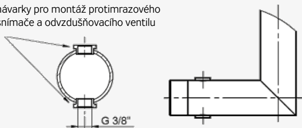
Obrázek 17 – montáž protimrazového snímače
