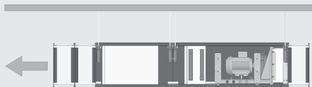
Obrázek 2 – zavěšení pod stropem
