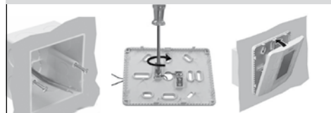
Obrázek 20 – montáž do elektroinstalační krabice
