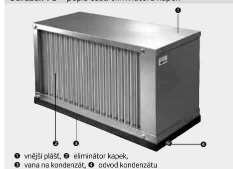
Obrázek 73 – popis částí eliminátoru kapek
