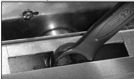
Obrázek 7 – Osový šroub uvolněte klíčem č. 24
