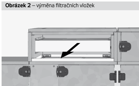
Obrázek 2 – výměna filtračních vložek
