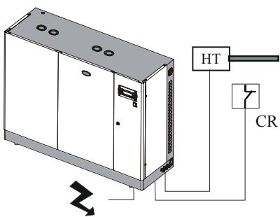
Возможно подключение optionalного датчика-ограничителя влажности (см. Рис. 5.7): в соответствии с данной конфигурацией, типичной для систем центрального кондиционирования, контроллер осуществляет управление по датчику влажности НТ и ограничивает производство пара по датчику СН, который замеряет уровень влажности в воздуховоде.
