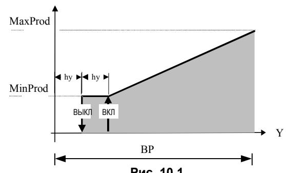
Функция осушения, при включении (п. 7.3.6.4), перекрывает диаграмму управления и запускается, когда измеренный датчиком уровень влажности выше уставки St на запрограммированную величину (отклонение осушения); гистерезис шага тоже программируется с помощью параметра "дифференциал осушения".
