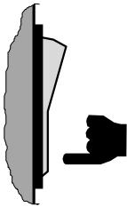
После процедуры принудительного слива увлажнитель продолжит работу (при наличии запроса на увлажнение). Следовательно, при замене цилиндра после завершения процедуры принудительного слива увлажнитель следует немедленно выключить.
