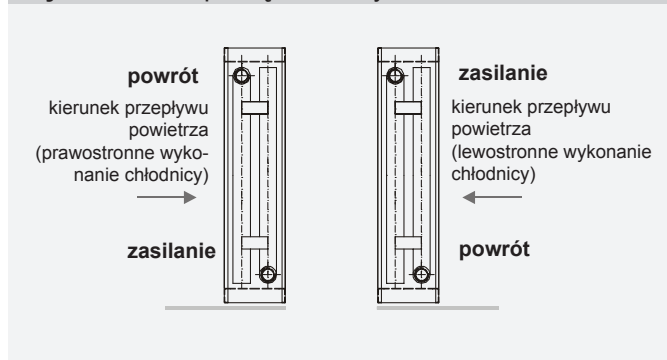
Rysunek 13 – podłączenie wymiennika
