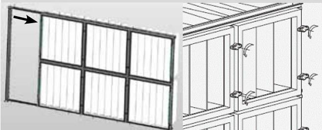
3) В некоторых случаях фильтрационные вставки устанавливаются в фильтрационных стенах, состоящих из укладочных рам. В эти рамы фильтры закрепляются при помощи зажимов в углах укладочной рамы.
