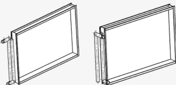
Места подсоединения на панели секции обозначены при помощи наклеек (подвод отопительной воды, отвод отопительной воды, подвод хладагента, отвод хладагента). Диаметр подсоединения соответствует параметрам теплообменника и определяется в технической документации вентиляционной установки. Размеры G1"-G3.
