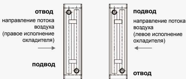
После подключения водяных теплообменников (обогревателей, охладителей и смесительных узлов) к сети, необходимо опрессовать их водой (залив водой) и обезвоздушить систему. Проверить герметичность соединений и теплообменника (включая осмотр внутри секции с водяным теплообменником).
