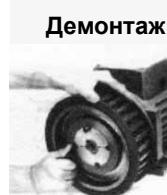
Необходимо ослабить зажимные винты и установить один или два (в зависимости от размера втулки) в отжимное отверстие. Слегка постучать по шкиву. Затянуть установленные винты, пока не произойдет отделение затяжной втулки и шкива.
