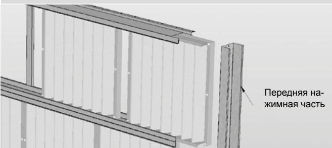
2) Фильтрационные вставки карманных, компактных, металлических и жировых фильтров устанавливаются в отдельные части фильтрационной стены. Замена фильтров происходит с грязной стороны. При замене необходимо выкрутить крепежные замки и вставку заменить. Перед установкой новых вставок необходимо проверить уплотнение. Перед закреплением замков необходимо проверить отцентрирование вставки в раме. Стену засунуть вплотную в установку.
