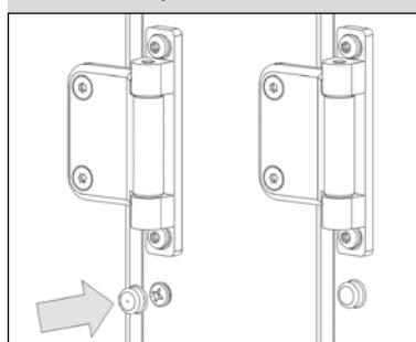
**Рис. 9 – внутреннее соединение секций**
