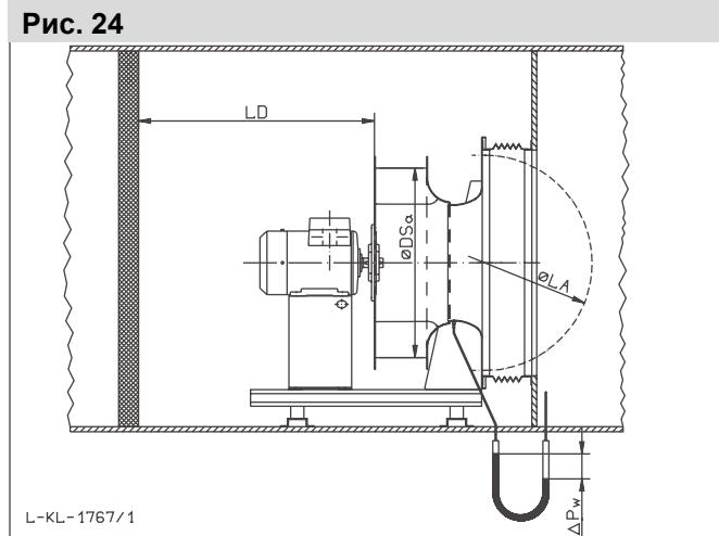
Расход воздуха (через вентилятор) устанавливается расчетом по уравнению:
