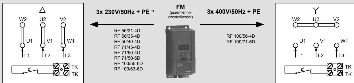
Rysunek 5 – podłączenie Y/Δ na listwie zaciskowej silnika 3f azowego
