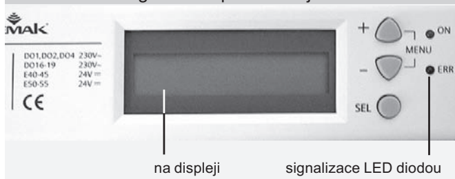
Obrázek 7 – signalizace poruch na jednotce
