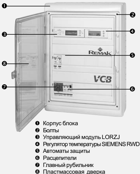
Рис. 4 – конструкция блока VCB
