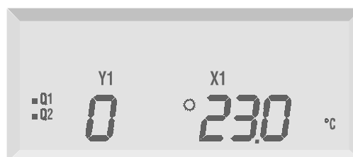
Rys. 11 Przykładowe wskazania wyświetlacza RWD 68
