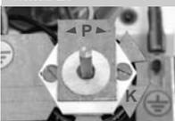
◀ Blokiranje izbranega nivoja moči se izvede s prepogibom pripadajoče pločevine kulise K navzgor, pod kotom 90°. S tem se prepreči prehodnost pauca vrtljivega preklonnega stikala P z lego ustreznega nivoja.
