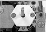
◀ Blokirajo se lahko nivoji moči 0-3 s prepogibom pripadajočih pločevin kulise 0 1 2 3. Blokira se lahko en nivo ali obseg dveh, treh ali štirih zaporednih leg vrtljivega preklonnega stikala.
