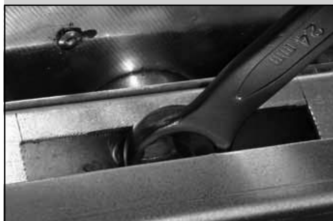
Obrázok 7 – osovú skrutku uvoľnite kľúčom č.24
