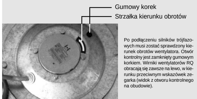
Rysunek 10 – gumowy korek otworu kontrolnego
