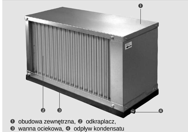
Rysunek 59 - opis części odkraplacza
