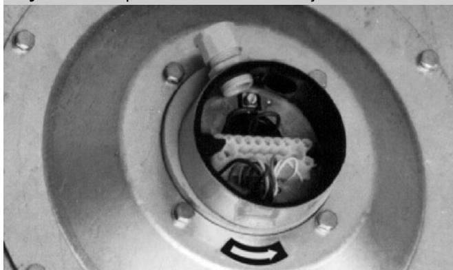
Rysunek 9 – plastikowa listwa na stojanie silnika
