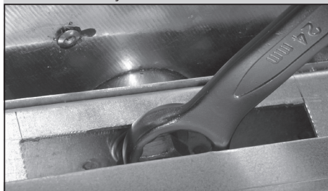
Obrázek 7 – Osový šroub uvolněte klíčem č. 24
