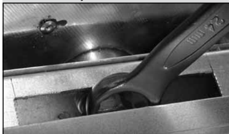
Obrázek 7 – Osový šroub uvolněte klíčem č. 24
