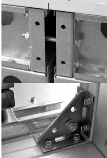
Obrázek 9 – spojení rámu a rohové spojení sekcí
