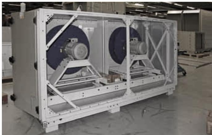
Сейсмическое исполнение соединительной рамы вентиляционной установки, в углах дополнено укрепление.
