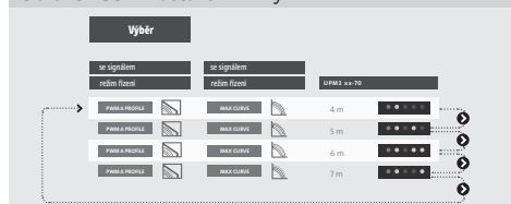
Obrázek 40 – Uzamčení nastavení čerpadla
