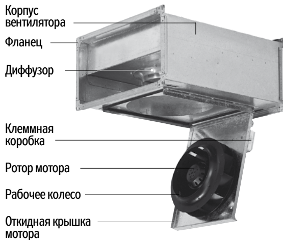
РИС. 3 – СОСТАВ ВЕНТИЛЯТОРА R0 (ОТКРЫВАЮЩИЙСЯ ТИП)
