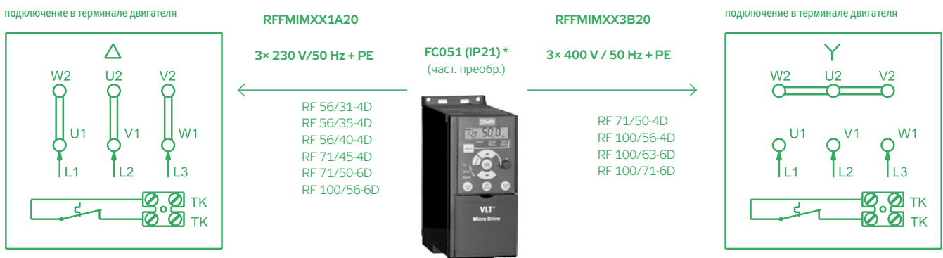
РИС.3 – ВКЛЮЧЕНИЕ Y/Δ НА КЛЕММНИКЕ ТРЕХФАЗНОГО ДВИГАТЕЛЯ С ЧАСТОТНЫМ ПРЕОБРАЗОВАТЕЛЕМ, FC051 (IP21) – RFFMIMXXXX20
