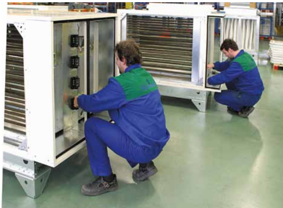
Установка поставляется комплектно, включая все уплотнительные и соединительные элементы.
