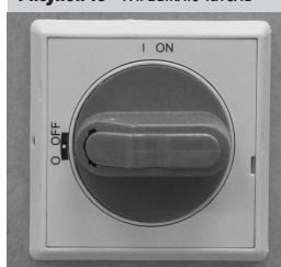
Если в состав компактной установки входит встроенный блок управления, на сервисной стороне оснащена главным выключателем (красный выключатель в желтом поле).
