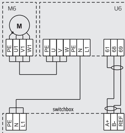
подключение мотора и частотного преобразователя
