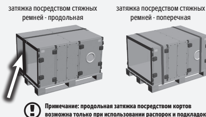
Рис. 4 – затяжка секций посредством стяжных ремней и лент
