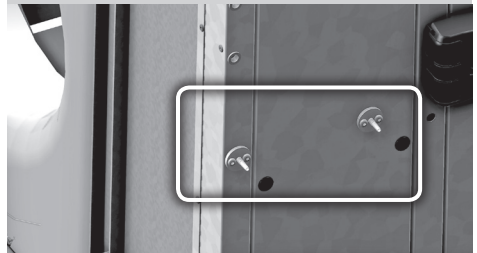
Рис. 25 – съемные зонды вентилятора
