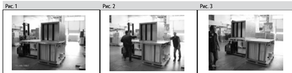
Рис. 1 подготовленные поддоны к перемещению верхней секции на поддон
