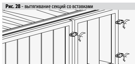
Рис. 28 - вытягивание секций со вставками
