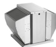
Strešné ventilátory RF s dozadu zahnutými lopatkami majú elektromotory s tepelnou poistkou vyvedenou do svorkovnice. Ventilátory musia byť za prevádzky chránené ochranným prvkom ovládaným kontaktom termopoistiek (termokontaktov TK)\*. Ventilátory sú napäťovo regulovateľné pomocou regulátorov TRN alebo TRRE/TRRD, trojfázové typy ventilátorov sú plynule regulovateľné pomocou frekvenčných meničov.
