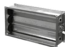
*Tesné lamelové uzatváracie a regulačné klapky slúžia k zaregulovaniu vzduchotechnického systému alebo k ručnému uzavretiu potrubných vetiev. Ovládanie je ručnou pákou a mechanickou aretáciou polohy.*
