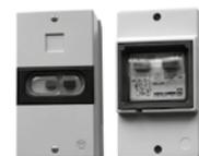
Ochranné relé jednofázových STE a trojfázových STD ventilátorov je nutné použiť v prípade, že ventilátory nie sú tepelne chránené riadiacou jednotkou REMAK alebo regulátorom TRN, príp. RFFM alebo nemajú samočinnú internú ochranu (napr. niektoré ventilátory RO). K ochrannému relé, ktorým je možné taktiež ventilátory ručne spúšťať a zastavovať, musia byť pripojené termo-kontakty TK chráneného ventilátora.
