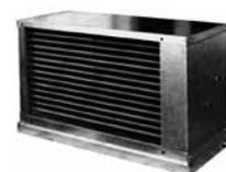
Vodné chladiče CHV s izoláciou proti kondenzácii sú vyrobené z Cu ruriel s presahom navlečenými Al lamelami. Plášť chladiča je štandardne vyrobený z pozinkovaného plechu a obsahuje tiež plastový eliminátor kvapiek a vaňu odvodu kondenzátu. Vodné chladiče sa bežne regulujú zmiešavacími uzlami SUMX. CHV sú dodávané štandardne v trojradom ľavom prevedení pri pohľade v smere prúdenia vzduchu. Prevedenie iného typu (pravé, bez eliminátora, príp. dvojradové) je možné na objednávku.
