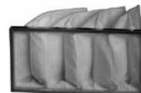
Kapsové filtračné vložky KF3 (trieda filtrácie G3), KF5 (trieda filtrácie M5) a KF7 (trieda filtrácie F7) sú určené pre kazety kapsových filtrov KFD. Filtračný materiál je osadený a utesnený v rámečku z pozinkovaného plechu. Vložky sú neregenerovateľné, po dosiahnutí konečnej tlakovej straty sa vymieňajú za nové.
