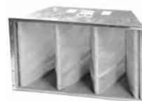
Filtračné vložky VF3 (filtrácia G3) sú určené pre kazety filtrov VFK. Vložka je tvarovo vystužená a je osadená a utesnená v kazete z pozinkovaného plechu. Vložky sú len obmedzene regenerovateľné. Vo vložkách sa vymieňa iba filtračná tkanina (pásky VF3N).
