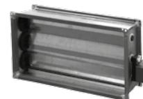
Tesné lamelové uzatváracie a regulačné klapky LKSX sa najčastejšie používajú ako zmiešavacie, vstupné a výstupné uzatváracie - regulačné. Obe koncové polohy (otvorené - zatvorené) je možné obmedziť mechanickými dorazmi na servopohone. Ovládanie je motorické servopohonom s proporcionálnou reguláciou polohy s napájaním 24 V AC/DC a riadiacim signálom 0-10 V DC.
