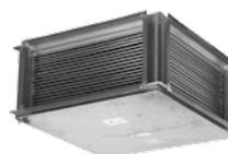
Doskový rekuperátor HRV je konštruovaný pre zaradenie do systému vzduchotechnických zariadení ako s paralelným vedením trasy prívodu a odvodu vzduchu, tak kolmým a šikmým pod uhlom 45° a ich rôznymi kombináciami. Prietok vzduchu rekuperátorom je krížový. Rekuperátor je osadený teplovýmennou vložkou z tenkých Al plechov. S rekuperátorom sa dodáva súprava na odvod kondenzátu.
