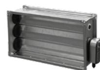
Tesné lamelové uzatváracie klapky LKSF s bezpečnostnou funkciou sa najčastejšie používajú ako vstupné uzatváracie. Ovládanie je motorické servopohonom pre napätie 230V AC. Servopohon klapku uzavrie havarijnou pružinou i pri výpadku napájania, čím sa znižuje riziko zamrznutia vodného ohrievača.
