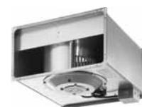
Radiálne potrubné ventilátory RP s dopredu zahnutými lopatkami majú jednofázové (E) a trojfázové (D) elektromotory s tepelnou poistkou vyvedenou do svorkovnice. Ventilátory musia byť za prevádzky chránené ochranným prvkom ovládaným kontaktom termopoistiek (termokontaktov TK). Ventilátory sú napäťovo regulovateľné pomocou regulátorov TRN alebo TRRE/TRRD.
