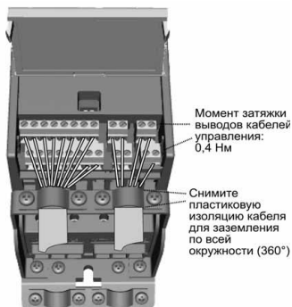
Рисунок 6: Смонтируйте кабели управления. См. следующую страницу!
