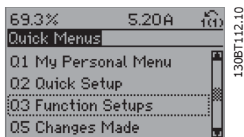
Obrázek 6.4: Krok 3: Pomocí navigačních tlačítek nahoru a dolů přejděte na Nastavení funkcí. Stiskněte tlačítko [OK].
