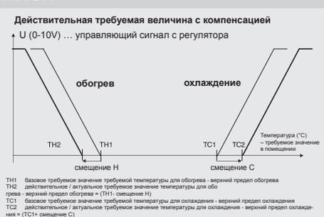
Установка компенсационного/корректирующего влияния (меню корректирующего значения). Способ коррекции является линейным и подвергается настройке (+/- и кривизна) – самостоятельно для требуемого значения обогрева и охлаждения.
