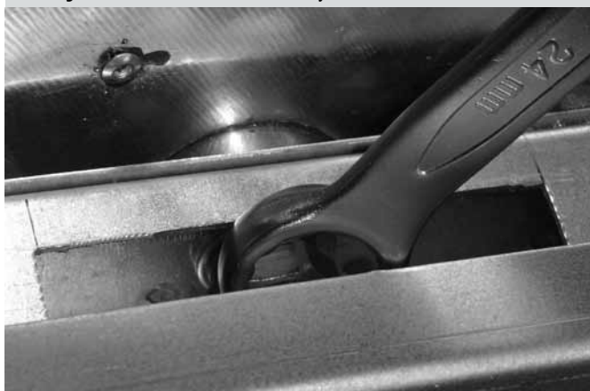
Рисунок 8 — Осевой болт отпустить ключом №24
